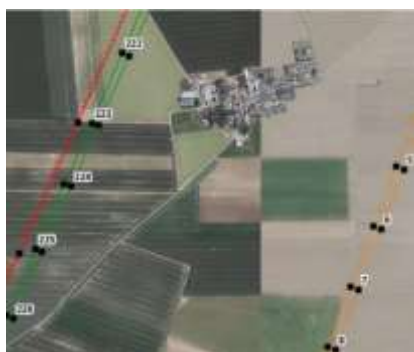
Figure 5 : Exemple de représentation de lignes et de pylônes sur un SIG
